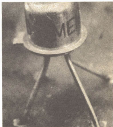
Il MOS-FET, elemento molto delicato, deve essere saldato evitando di accorciare troppo i terminali per evitare pericolosi sovraccarichi di temperatura.
